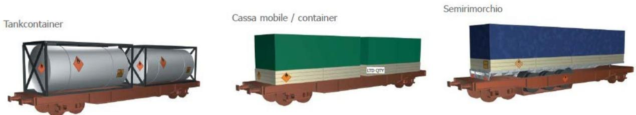
Figura 17: possibili collocazioni dei pannelli di pericolo e di identificazione
